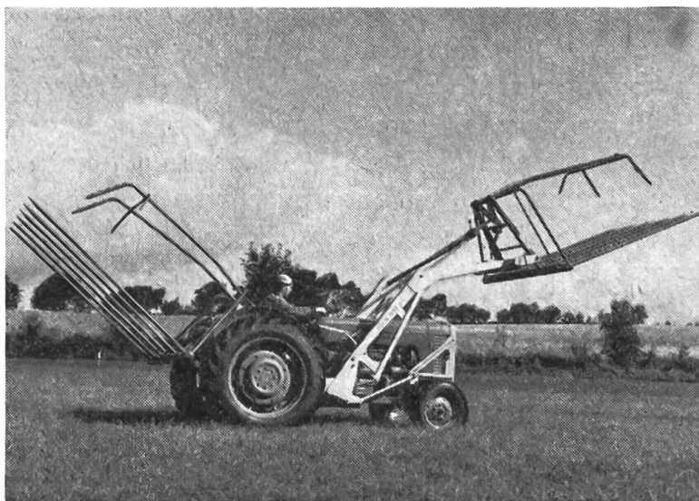
Fig. 1: Tracteur équipé de deux fourches transporteuses à fourrages secs, l'une étant fixée aux trois points d'attelage du dispositif de relevage hydraulique, l'autre aux bras du chargeur frontal.
