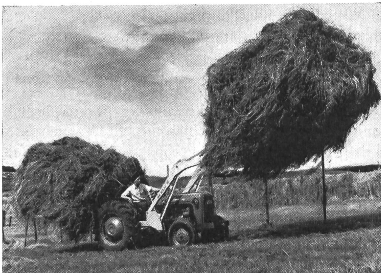
Fig. 2: L'emploi simultané de deux fourches transporteuses à fourrages secs permet comme on le voit de ramasser et rentrer à chaque course un volume relativement important de foin, qui peut représenter approximativement 600 à 700 kg.
