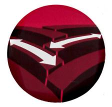
les puissantes arêtes des crampons augmentent le pouvoir de traction et donnent une assise parfaite au tracteur
