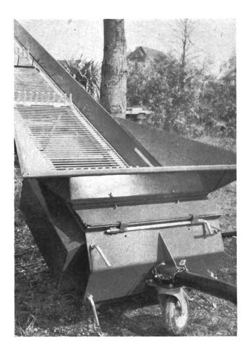
Fig. 5: Elévateur à tapis métallique équipé d'un entonnoir d'alimentation et d'une roulette de transport.
