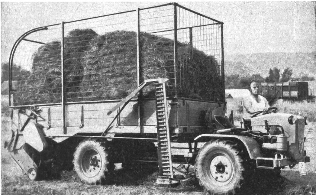
**La faucheuse-chageuse PULLAX** réunit en une seule unité, le char chargeur, la faucheuse, l'épandeur d'engrais et le char déchargeur, p. ex. pour betteraves, pommes de terre, etc. Il peut être démonté partout en un tournemain, le PULLAX étant alors prêt à servir de tracteur agricole avec système hydraulique normalisé, de tracteur forestier idéal, tracteur basculant, pour l'évacuation de la neige, etc. Le MERK-PULLAX est livrable avec moteur 12/20/40 CV à partir de Fr. 9800.—
