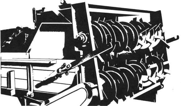
Mécanisme de distribution avec rouleaux en colimaçon sans supplément de prix. Chaîne d'avancement à articulations avec traverses sur tout le pourtour. Marche avant et arrière de la chaîne. Réglage de la distribution depuis le siège du tracteur (7 possibilités).
