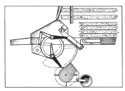
Fonctionnement du mécanisme oscillant double à l'autochargeuse type LD avec dispositif de coupe (coupe à la manière de ciseaux).
