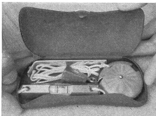
Fig. 2: Replié et rangé dans son étui, l'indicateur de pente en question prend très peu de place et se glisse facilement dans la poche du veston.
