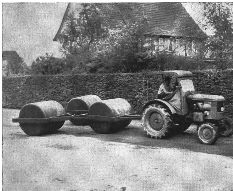
Fig. 2: Rouleau lisse à prairies formé de trois éléments. (Le bâti de l'élément de devant est muni de deux portants latéraux auxquels s'accrochent les deux éléments de derrière).
