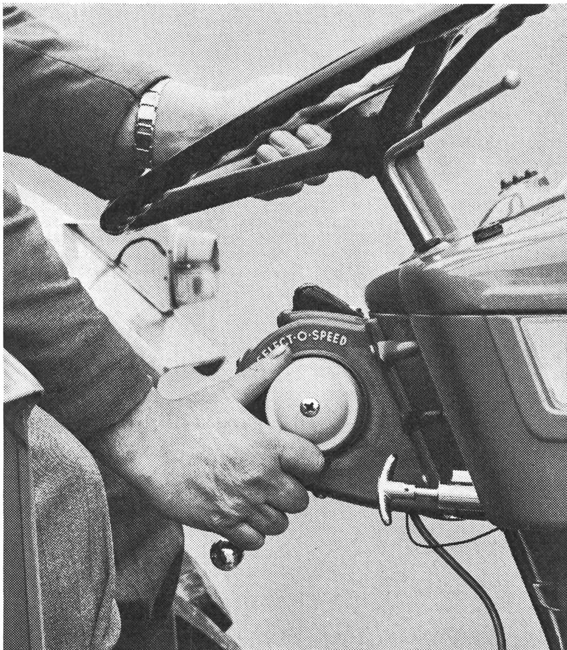
Main gauche sur le volant, main droite sur le levier de la boîte Select-o-Speed, et on part! Neuf vitesses avant, deux en arrière, pas d'arrêt, pas d'em-
