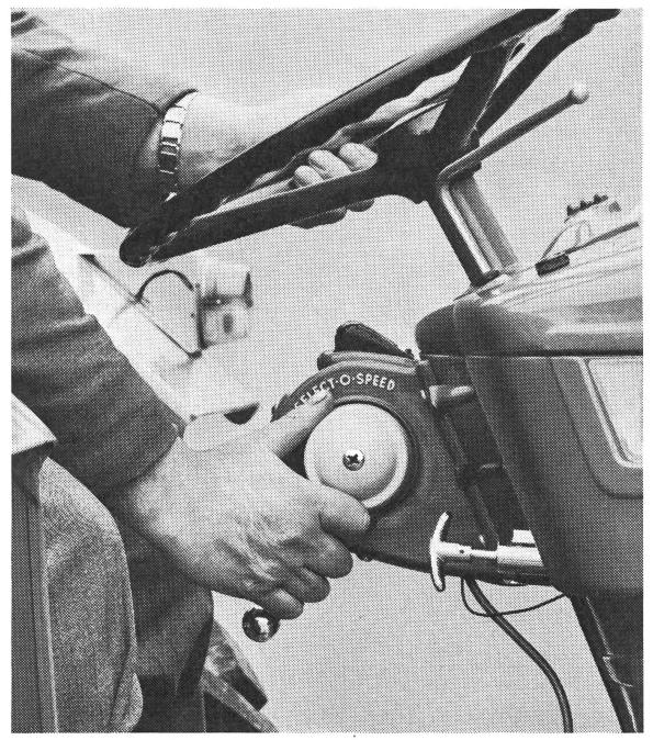
Main gauche sur le volant, main droite sur le levier de la boîte Select-o-Speed, et on part! Neuf vitesses avant, deux en arrière, pas d'arrêt, pas d'em-
