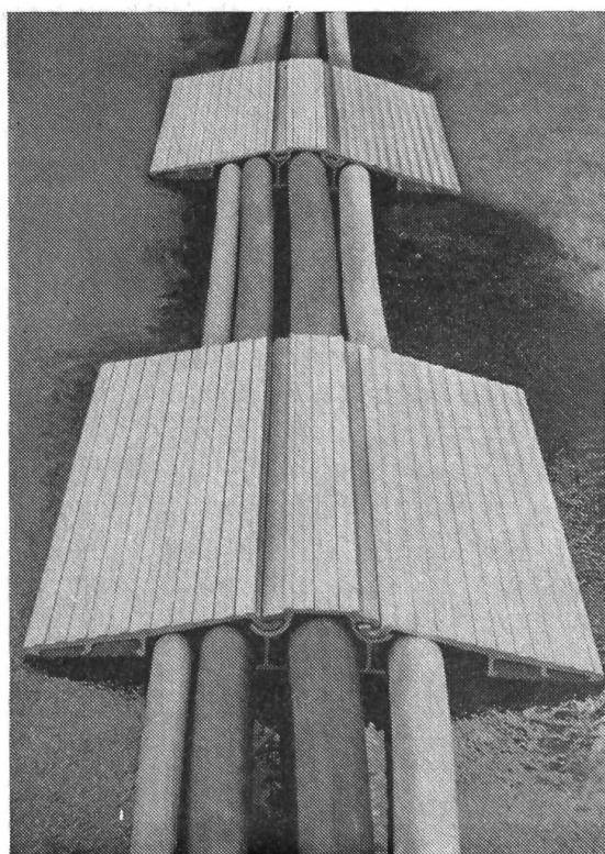
tions. Elle a normalement 60 cm de large et 9 cm de haut. Etant en aluminium, son poids, d'environ 18 kg, ne dépasse pas celui d'une même passerelle en bois. Par ailleurs, on peut la replier (grâce à ses articulations) et aussi la démonter, ce qui, dans les deux cas, permet d'économiser de la place lors de son entreposage.
