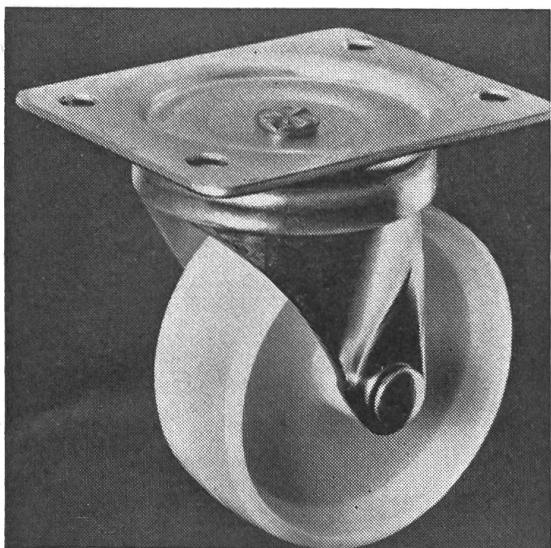
Aspect d'une roulette «Pévolon» en plastique du type roulette de fauteuil, qui ne demande aucun entretien. Cette roulette résiste bien à l'usure, à la rupture et à l'action corrosive des agents chimiques.
