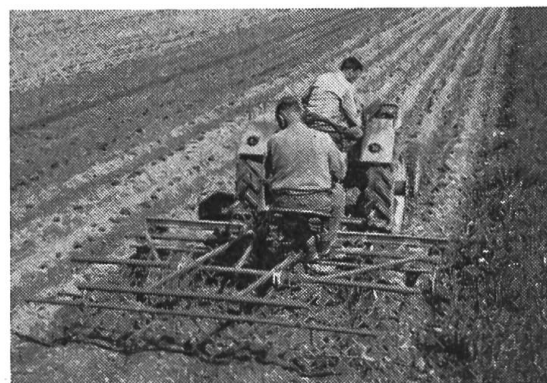
Fig. 5 et 6: En utilisant des corps sarcleurs ou butteurs avec la herse-étrille, on arrive à lutter efficacement contre les mauvaises herbes.
