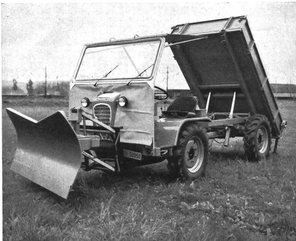
Une **benne basculante** et un **chasse-neige** sont le complément idéal du tracteur forestier PULLAX pour les travaux de construction et d'entretien des routes. Grâce à ses deux essieux moteurs et à son bas centre de gravité, le Pullax tire sans peine les plus lourdes billes !
