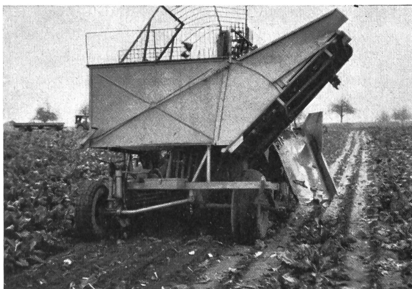
Aspect d'une machine du type tracté effectuant la récolte totale des betteraves à sucre. (Les collets et feuilles de 4 à 6 lignes sont disposés en un andain longitudinal.)
