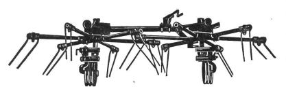
Fig. 16: Aspect de la faneuse à toupies «Bautz», qui ne comprend que 2 toupies pour sa largeur de travail de 2 m 70. Pour la mettre en position de transport, il suffit de démonter les bras qui se trouvent à l'extérieur. Sa largeur n'est alors plus que de 1 m 90.
