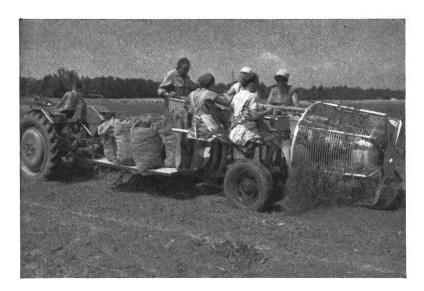
Fig. 21: Arrivé en bout de champ, on roule avec l'arracheuse-ramasseuse «Samro-Junior» jusqu'à un véhicule de transport ayant été amené là, et parallèlement à lui. On relève alors hydrauliquement la plate-forme de la récolteuse qui est accouplée au dispositif d'attelage trois-points du tracteur, de telle sorte que les sacs puissent être facilement transbordés de l'arracheuse-ramasseuse sur le véhicule de transport
