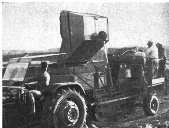
Fig. 18 et 19: Aspects de la machine «Hassia» prévue pour la récolte totale des pommes de terre. Un dispositif épierreur, comportant des brosses rotatives en nylon, permet, suivant les conditions de travail, d'éliminer jusqu'à 70 à 90 % des cailloux. En équipant cette machine d'une trémie collectrice, on arrive à alléger le travail dans une large mesure et à diminuer aussi de beaucoup le nombre des heures de travail nécessaires.
