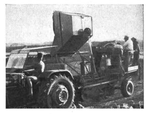
Fig. 18 et 19: Aspects de la machine «Hassia» prévue pour la récolte totale des pommes de terre. Un dispositif épierreur, comportant des brosses rotatives en nylon, permet, suivant les conditions de travail, d'éliminer jusqu'à 70 à 90 % des cailloux. En équipant cette machine d'une trémie collectrice, on arrive à alléger le travail dans une large mesure et à diminuer aussi de beaucoup le nombre des heures de travail nécessaires.
