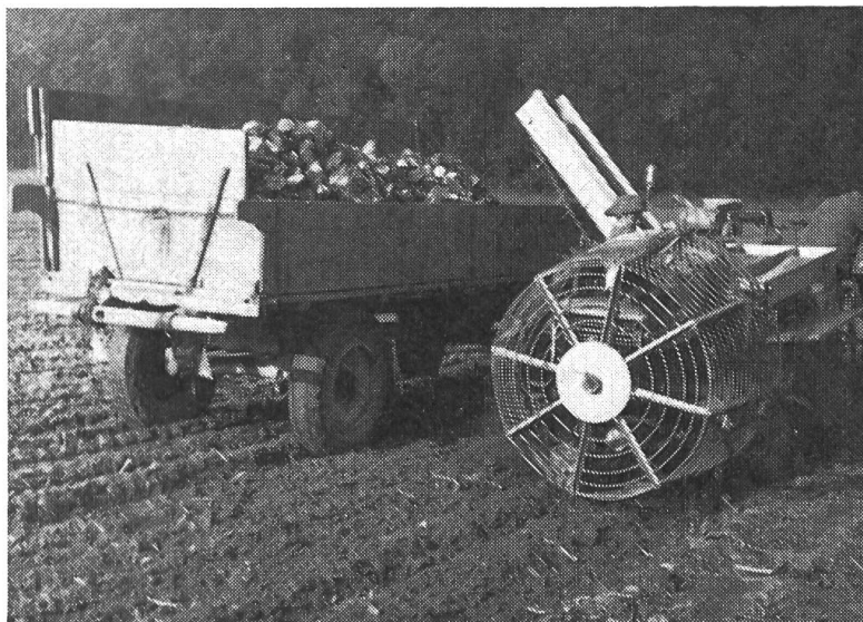
Aspect d'une arracheuse-ramasseuse de pommes de terre transformée pour la récolte des betteraves sucrières en l'équipant d'une corbeille tronconique appropriée et d'un élévateur-chargeur
