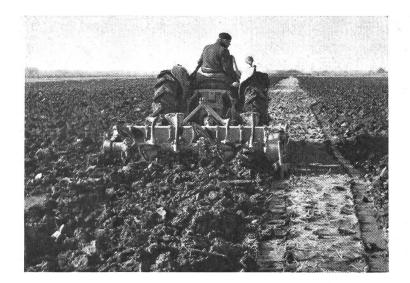
Fig. 12: La motobineuse «Vicon-Rotespa» à bêches vue au travail. Ce matériel de fabrication hollandaise, actionné par la prise de force, est pourvu de bêches actionnées individuellement qui lui permettent de fournir un travail d'une qualité sensiblement égale à celle qu'on obtient avec la charrue. Les tranches de terre découpées sont bien retournées, et, de plus, émiettées de façon grossière.
