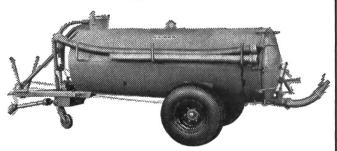
La nouvelle pompe M 3 à 3 lames seulement, munie d'un réservoir de 3 litres d'huile, d'une jauge graduée et d'un graissage automatique à l'aspiration et au refoulement, facilite l'utilisation en société.
