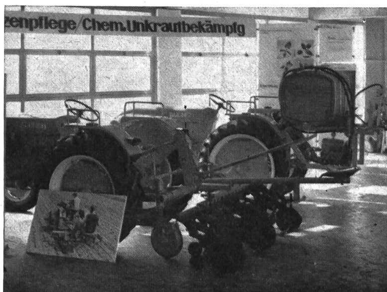
Fig 4: Un démariage manuel rapide présuppose la destruction chimique préalable des mauvaises herbes. Divers produits désherbants susceptibles d'être employés, ainsi qu'un pulvérisateur porté, signalaient au visiteur l'importance de la destruction chimique des mauvaises herbes. Pour le sarclage, l'instrument universel avec socs bineurs montés sur parallélogrammes articulés continuera de jouer un rôle primordial.
