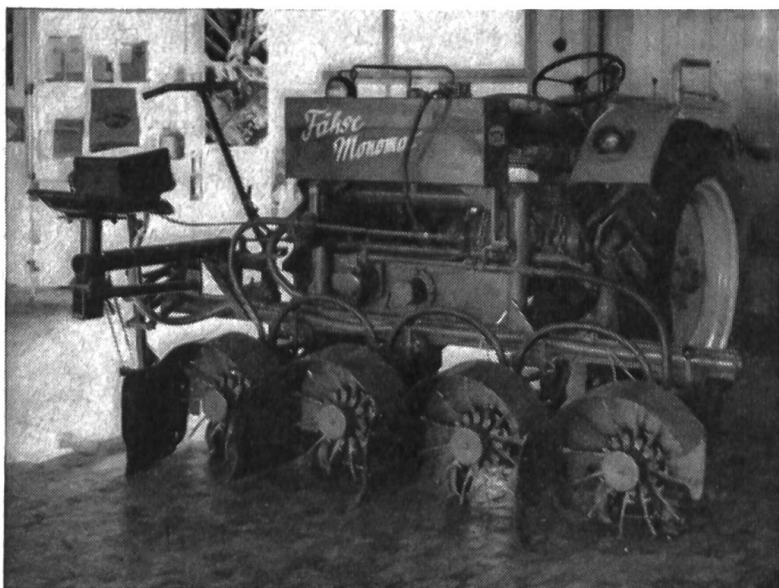
Fig. 5: Aspect de la démarieuse à tâteurs électroniques qui représente la solution de l'avenir et fut très remarquée à cette exposition. On sait que la mécanisation du démariage des betteraves sucrières est désirée depuis longtemps. Il reste à souhaiter qu'une telle machine puisse être mise bientôt à la disposition des praticiens.
