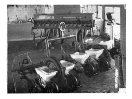
Fig. 3: Le semoir monograine a vivement intéressé les visiteurs. Un seul levier de réglage permet de choisir six distances différentes pour l'espacement des graines dans la ligne. En outre, la distance séparant un semoir monograine de l'autre peut être facilement modifiée par coulissement de ces éléments sur la barre porteoutils. Le semoir porté de type traditionnel que l'on voit à l'arrière-plan convient aussi très bien pour la mise en terre de graines monogermes.
