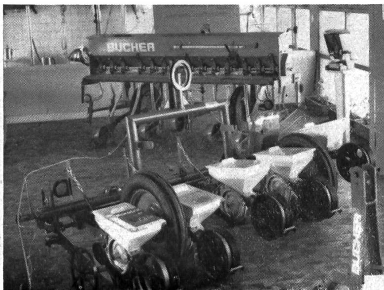
Fig. 3: Le semoir monograine a vivement intéressé les visiteurs. Un seul levier de réglage permet de choisir six distances différentes pour l'espacement des graines dans la ligne. En outre, la distance séparant un semoir monograine de l'autre peut être facilement modifiée par coulisement de ces éléments sur la barre porte-outils. Le semoir porté de type traditionnel que l'on voit à l'arrière-plan convient aussi très bien pour la mise en terre de graines monogermes.
