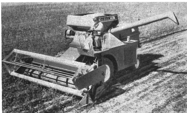
Fig. 2: Le système Uni: centrale d'énergie (tracteur) sur laquelle a été montée une moissonneuse- batteuse.
