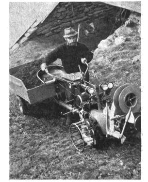
Fig. 10: Des roues d'adhérence supplémentaires à barreaux facilitent la progression en marche oblique sur les terrains en pente.
