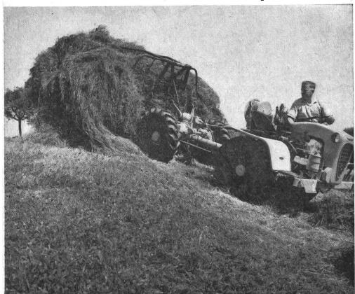
La **ramasseuse-pinces** adaptée au Pullax représente la solution idéale (pour le ramassage et le transport des fourrages), grâce à la surcharge de l'essieu avant. Tous les matériels prévus pour relevages hydrauliques à attelage trois-points normalisé (charrues, faneurs rapides, etc.) peuvent être utilisés avec le Pullax. Le PULLAX existe dans les catégories de puissance de 12 ch, 20 ch et 40 ch. — Prix: à partir de Fr. 9800.—
