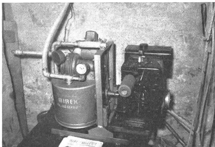
Dans les endroits dépourvus d'une installation électrique, le groupe motopompe peut être entraîné par un moteur à essence ...
