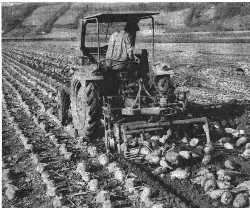
Fig. 5: Récolte des betteraves fourragères (contenant une forte proportion d'éléments nutritifs) à l'aide d'une arracheuse à trois rangs du type à cribles oscillants.
