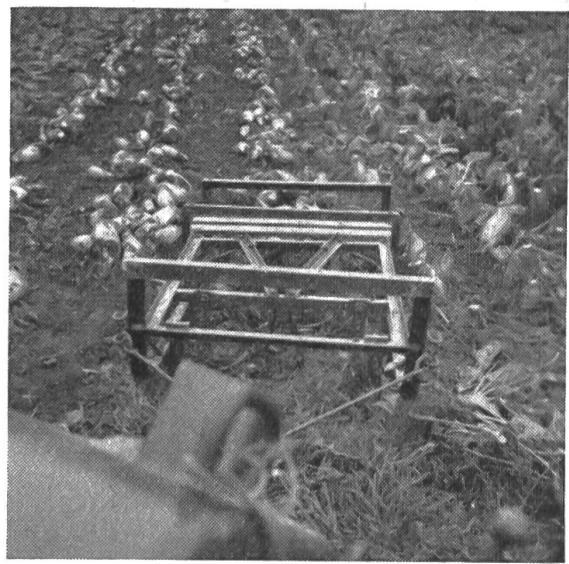
Fig. 4b: Traîneau arracheur danois pour deux rangs. Ne convient que pour des betteraves fourragères à haute teneur en éléments nutritifs et fortement enracinées.
