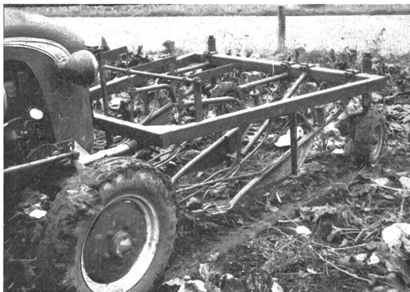
Fig. 3a: Décolleteuse de bet- teraves frontale ... (prototype)
