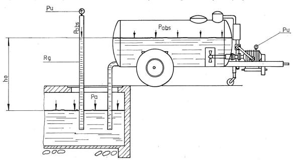
La hauteur d'aspiration théorique jusqu'à laquelle le liquide monte est calculée à partir de la condition d'équilibre de la colonne de liquide dans le tuyau imaginaire (Rg). Sur la section des colonnes à hauteur du niveau inférieur du liquide agit du dessous la pression (pa $\times$ F), du dessus le poids des colonnes (F $\times$ ho $\times$  $\gamma$ ) et au niveau du tuyau pabs $\times$ F la pression. On obtient par conséquent pa $\times$ F = F $\times$ ho $\times$  $\gamma$  +pabs $\times$ F
