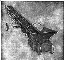
Avec bande en caoutchouc ou à chaînes, dans toutes les longueurs de 4 à 12 m. Choix varié pour tous les usages. Entre-autre notre élévateur MICA, commandé par moteur électrique et prise de force à prix très avantageux.
