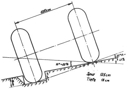
Si on laboure un champ suivant le sens des courbes de niveau, il convient donc de toujours travailler en versant vers le haut. De cette façon, les roues situées du côté amont cheminent dans le sillon et diminuent l'inclinaison du tracteur au lieu de l'augmenter. En outre, on évite un glissement latéral éventuel de la machine du fait qu'elle s'appuie contre la muraille du sillon, qui fait office de système de guidage.
