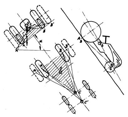
Fig. 1: Croquis montrant en élévation, en plan et de profil un tracteur à quatre roues spécialement équipé pour les terrains inclinés. Cette machine a un bas centre de gravité, son empattement à été allongé, et les roues arrière sont jumelées.
