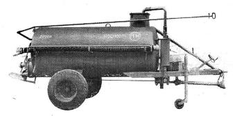
MFH Tonneau à pression Contenance 2200, 3000 I ou sur demande Pompe très puissante avec un rendement de 2700 I/min. Aspire du liquide plus épais, brasse mieux dans la fosse et dans le tonneau et gicle plus loin.
