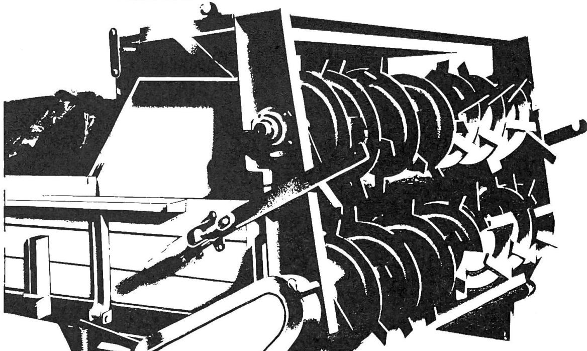
Mécanisme de distribution avec rouleaux en colimaçon sans supplément de prix. Chaîne d'avancement à articulations avec traverses sur tout le pourtour. Marche avant et arrière de la chaîne. Réglage de la distribution depuis le siège du tracteur (7 possibilités).
