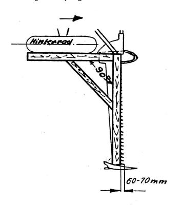
Mesurage de l'avance d'une barre de coupe latérale portée à l'aide d'une équerre de bois. Hinterrad = Roue arrière
