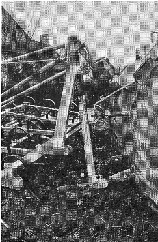
Fig. 2: Ce système fonctionne même si la machine de travail se trouve en position inclinée au bord d'un chemin. Il suffit que la roulette placée au haut du triangle du tracteur soit introduite dans la «rainure» d'un des côtés du triangle de la machine pour que l'accouplement soit amorcé.
