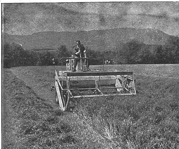
Fig. 8: Grande faucheuse automotrice équipée d'un conditionneur de fourrages et d'un dispositif andaineur
