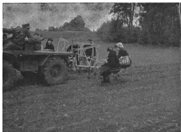
Fig. 4: Démarieuse semi-automatique dont les outils de sarclage (binettes à étrier mobile à mouvements commandés) sont manœuvrés par 4 personnes de service
