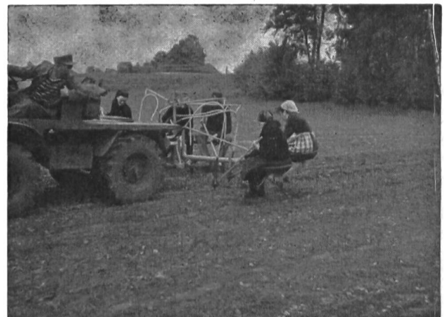
Fig. 4: Démarieuse semi-automatique dont les outils de sarclage (binettes à étrier mobile à mouvements commandés) sont manœuvrés par 4 personnes de service
