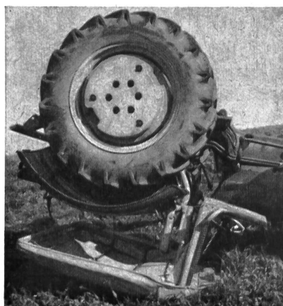
Fig. 4: Aspect d'un tracteur équipé d'un abri de sécurité que l'on a fait basculer sur une pente pour éprouver la solidité de ce système de protection. On peut constater qu'il en est sorti indemne. Il est donc certain que le conducteur s'en serait tiré sans grand dommage s'il avait pu se maintenir à l'intérieur de l'abri.
