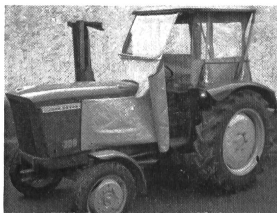
Fig. 2: Abri contre les intempéries, facilement démontable, qui permet de travailler par mauvais temps. Sa structure ne gêne ni la visibilité ni la liberté des mouvements. En été, on peut relever entièrement le pare-brise, enlever les parois latérales et enrouler le toit souple. Cet abri assure une bonne protection.
