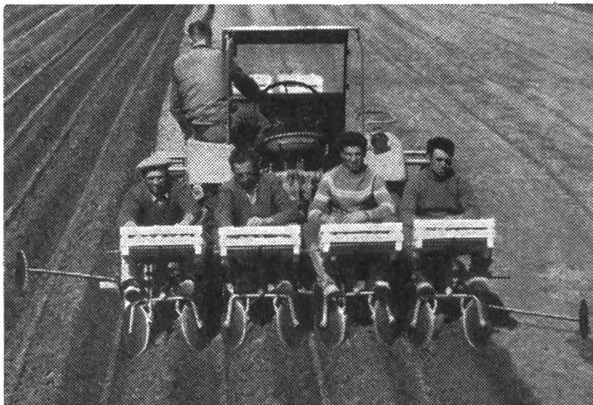
Plantation de pommes de terre sur 4 rangs avec nos planteuses semi-automatiques brevetées.
