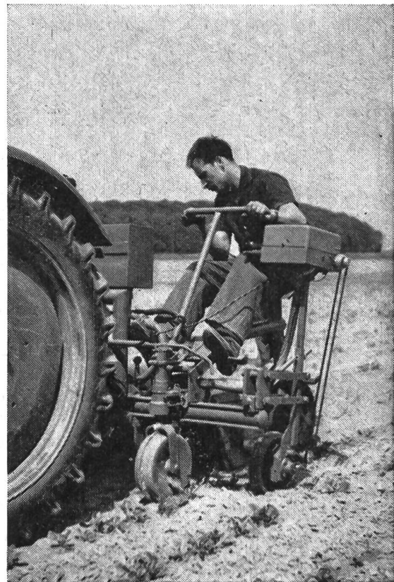
Fig. 3: Le boîtier de commande électronique se trouve à côté du pilote de la prédémariouse. Une courroie dentée, reliée au boîtier et tournant sur une roulette en contact avec le sol, provoque la réaction électronique après le franchissement des distances prévues.
