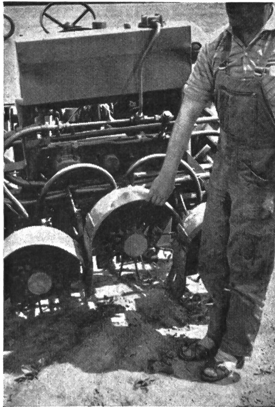
Fig. 2: Les fraises sont adaptées à des parallélogrammes individuels articulés, ce qui permet de rouler avec la prédémariouse (éclaircisseuse) même sur des terrains inégaux. La rotation continue des lames sarcleuses est commandée hydrauliquement, le relevage et l'abaissement des fraises l'étant électroniquement.
