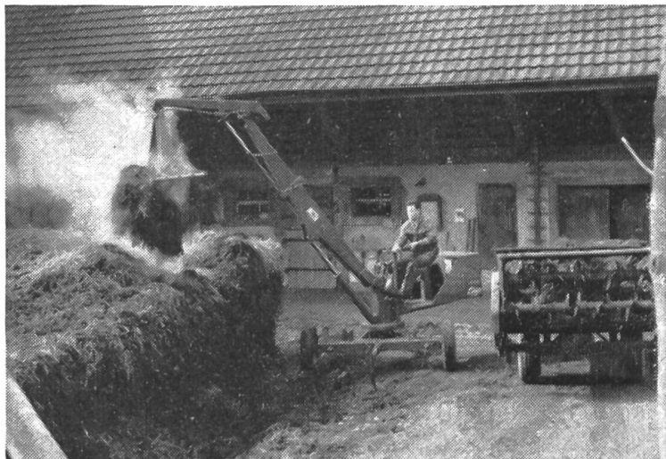
Fig. 6: Aspect d'une petite grue hydraulique à 4 roues qui a été équipée d'un moteur à explosion. Contrairement aux grues hydrauliques portées et semi-portées, cette machine peut travailler de manière indépendante, c'est-à-dire en n'étant pas accouplée au tracteur. Celui-ci se trouve donc disponible pour conduire l'épandeuse aux champs, autrement dit pour exécuter les travaux de fumure au moment où s'effectue le chargement du fumier.
