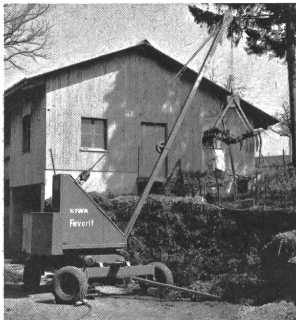
Fig. 4: Aspect d'une grue mécanique pivotante de type tracté, montée sur roues à pneu. Son entraînement a lieu soit par la prise de force du tracteur, soit par moteur électrique. On donnera la préférence à ce dernier (dans la mesure du possible), car il est de fonctionnement plus sûr qu'un moteur à explosion et représente aussi la solution la plus économique.
