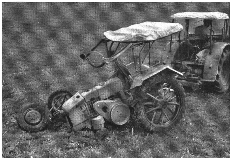
Fig. 5: Tracteur équipé d'un abri de sécurité et d'un étrier de protection (encadrement de pare-brise renforcé) — Aspect de la machine après qu'elle ait dévalé et roulé plusieurs fois sur elle-même sur une pente de 80 % de déclivité. L'abri n'a pas été endommagé. L'essieu avant et le bloc-moteur se sont rompus et détachés, par contre.
