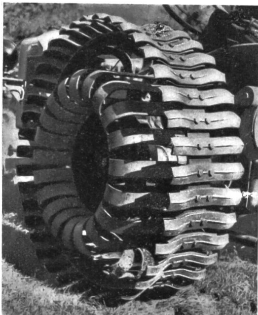
Roue de remplacement Meili employée pendant la dernière guerre mondiale, lorsque le caoutchouc était rare.
