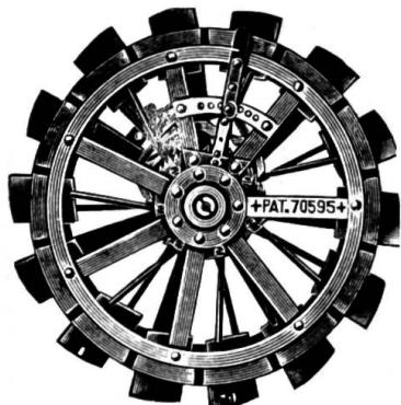
Aspect d'un des premiers types de roues réalisées pour les tracteurs agricoles, qui devaient permettre de faciliter et d'accélérer l'exécution des travaux dans les champs. Il s'agit du type Meyer, comportant des plaques de caoutchouc et des palettes rabattables.
