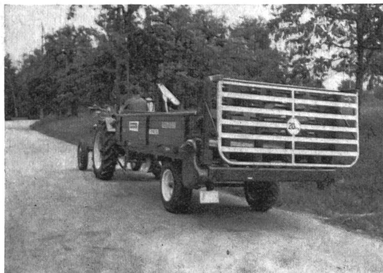
Fig. 3: Hérissons d'épandeur de fumier recouverts d'une corbeille de protection. Ce dispositif de sécurité a largement prouvé son efficacité puisque les accidents provoqués par le mécanisme d'épandage ont brusquement diminué après qu'on l'eut déclaré obligatoire.
