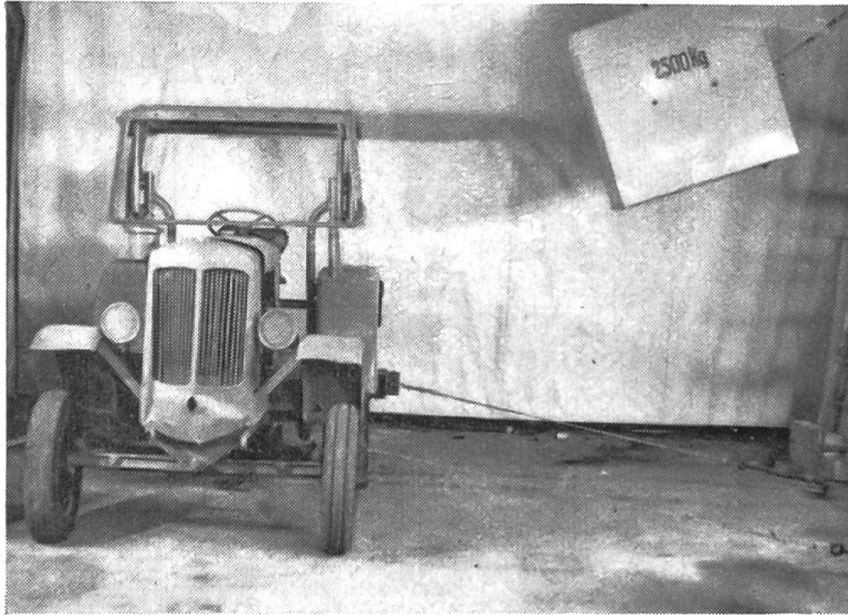
Fig. 3: Abri de tracteur agricole soumis à des essais au choc (bloc de béton suspendu de 2000—2500 kg lancé contre l'armature de l'abri).
