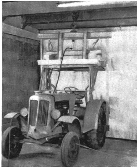
Fig. 4: Abri de tracteur agricole soumis à des essais de pression (compression par force hydraulique représentant deux fois le poids du tracteur).
