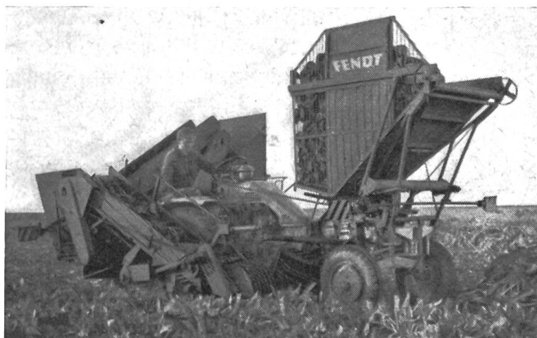
Fig. 10: Porte-outils automoteur sur lequel est adaptée une machine prévue pour la récolte totale des betteraves sucrières (décolleteuse-arracheuse- ramasseuse).
