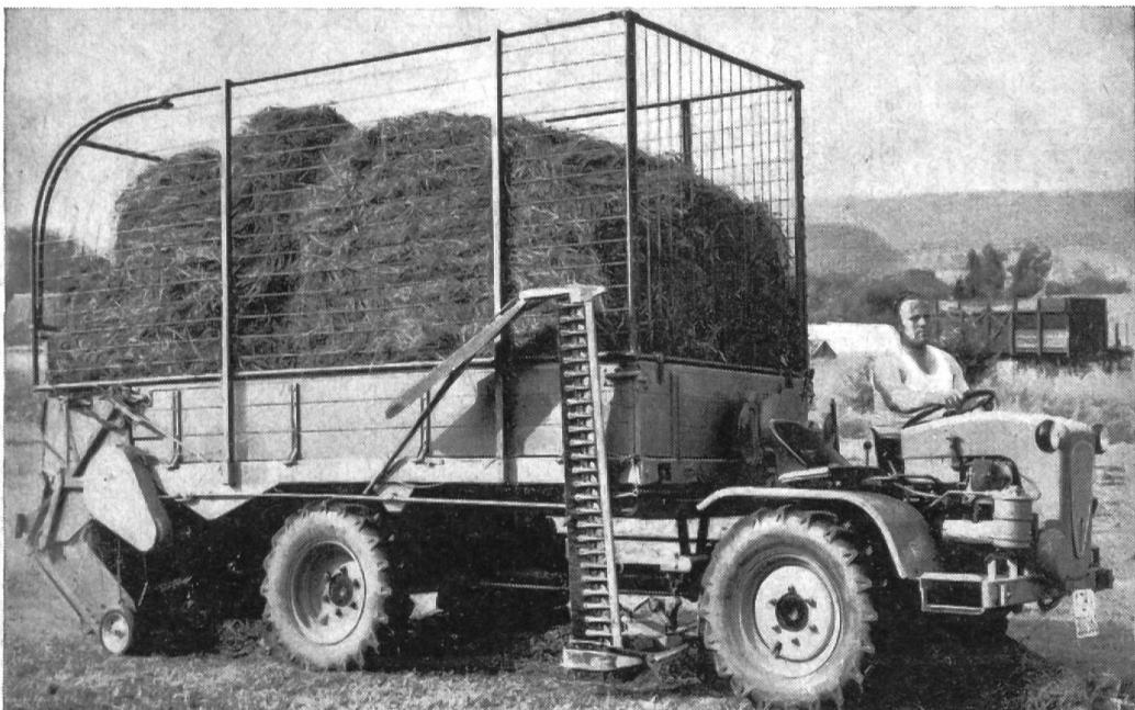
**La faucheuse-chageuse PULLAX** réunit en une seule unité, le char chargeur, la faucheuse, l'épandeur d'engrais et le char déchargeur, p. ex. pour betteraves, pommes de terre, etc. Il peut être démonté partout en un tournemain, le PULLAX étant alors prêt à servir de tracteur agricole avec système hydraulique normalisé, de tracteur forestier idéal, tracteur basculant, pour l'évacuation de la neige, etc. Le MERK-PULLAX est livrable avec moteur 12/20/40 CV à partir de Fr. 9800.—
