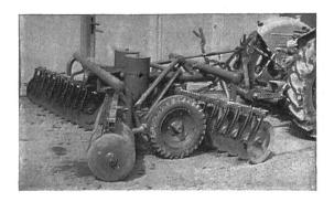
Aspect d'un pulvériseur à disques lourd de fabrication allemande. Il s'agit d'un instrument semi-porté pour attelage trois-points.
