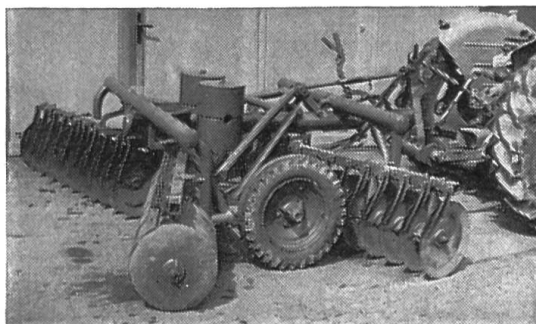
Aspect d'un pulvérisateur à disques lourd de fabrication allemande. Il s'agit d'un instrument semi-porté pour attelage trois-points.
