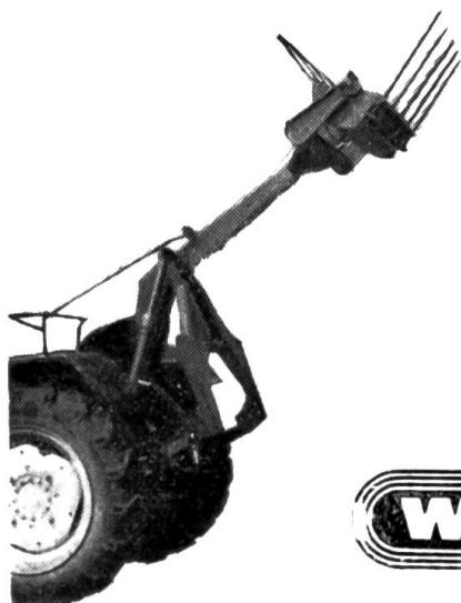
S'adapte à tout tracteur comportant un relevage hydraulique avec attelage 3-points.
