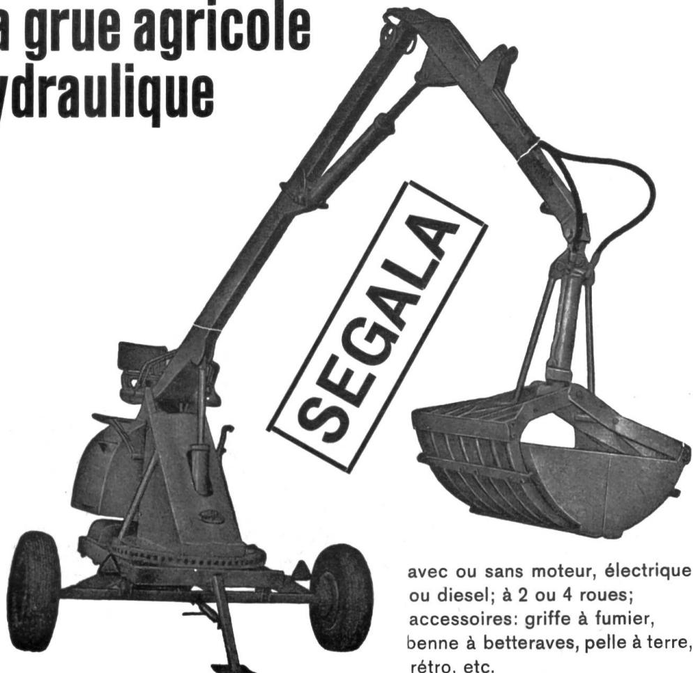
avec ou sans moteur, électrique ou diesel; à 2 ou 4 roues; accessoires: griffe à fumier, benne à betteraves, pelle à terre, rétro, etc.
