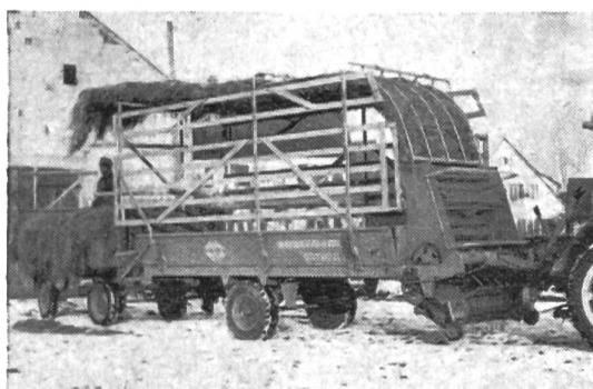
Remorque autochargeuse «Saturne» comportant un dispositif spécial qui permet de charger également d'autres véhicules de récolte, le tapis de fourrage comprimé étant poussé par-dessus les superstructures. Ce dispositif amovible coûte 250 marks. On peut également le monter sur la remorque autochargeuse «Wiedomat», provenant de la même fabrique.
