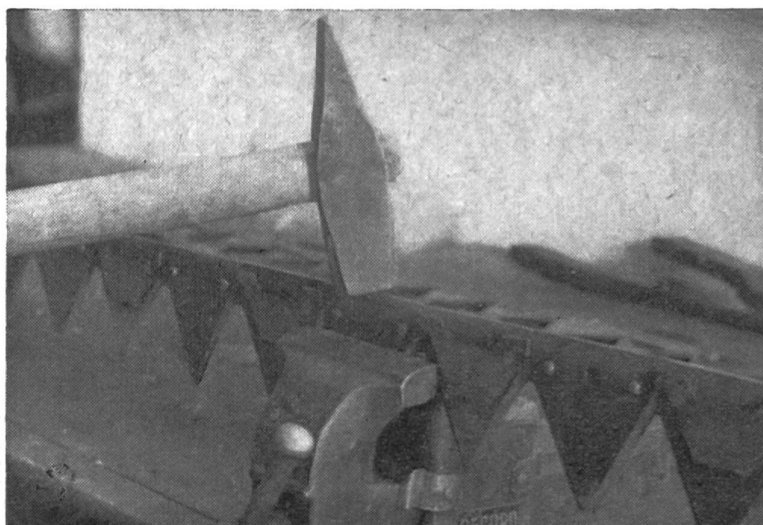
Fig. 6: Lorsqu'on veut cisailer les rivets des sections de cette façon, c'est-à-dire en martelant leur talon, on endommage presque toujours la tringle de lame.
