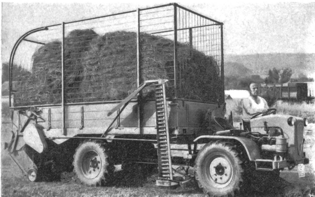
**La faucheuse-chARGEUSE PULLAX** réunit en une seule unité, le char chargeur, la faucheuse, l'épandeur d'engrais et le char déchargeur, p. ex. pour betteraves, pommes de terre, etc. Il peut être démonté partout en un tournemain, le PULLAX étant alors prêt à servir de tracteur agricole avec système hydraulique normalisé, de tracteur forestier idéal, tracteur basculant, pour l'évacuation de la neige, etc. Le MERK-PULLAX est livrable avec moteur 12/20/40 CV à partir de Fr. 9800.—
