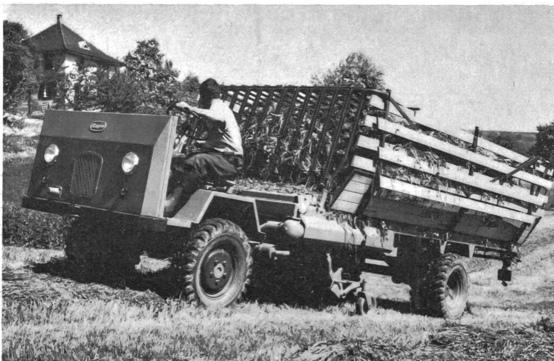
Fig. 2: Du fait que sa traction se trouve assurée par les quatre roues, que les roues arrière sont jumelées et que la charge des essieux a été judicieusement répartie, le Cargotrac «Rapid» ne provoque aucune compression nuisible du sol.
