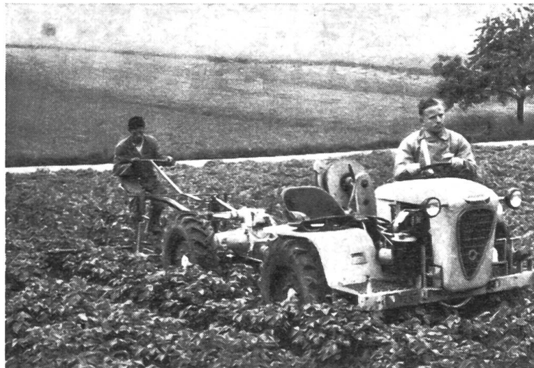
Fig. 6: Emploi du véhicule tous-terrains pour butter les pommes de terre dans une culture accusant une inclinaison de 25 %. Il n'est pas fait usage ici de la traction complémentaire par le cabestan. Si l'on utilise simultanément les roues motrices et la traction supplémentaire par câble, on dispose d'un tracteur «grimpeur» permettant de travailler sur des pentes d'un taux de déclivité atteignant presque 100 %.
