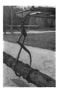
des planches, des troncs, des instruments agricoles, etc. Le crochet portecharge fait corps avec une solide traverse que l'on place dans les dispositifs de fixation à cheville et clavette des extrémités des bras du chargeur frontal.
