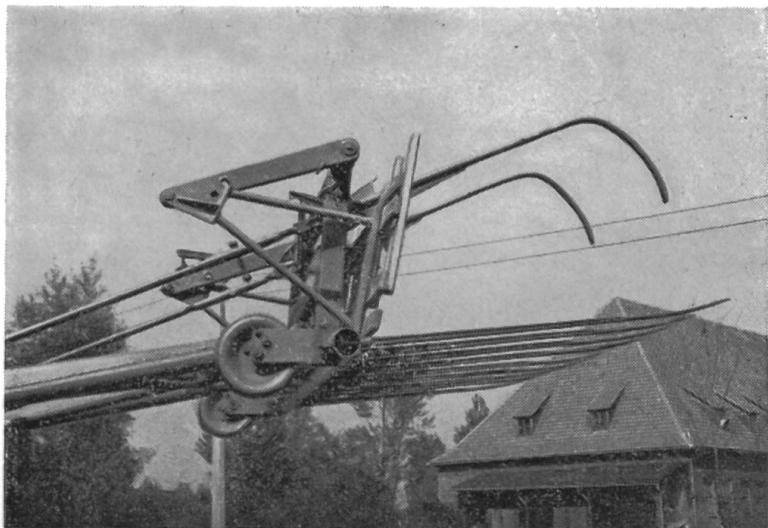
Cette photo montre le panneau déchargeur mobile en action (il est poussé par le vérin) et le relevage automatique de la griffe, qui s'effectue simultanément grâce à un système de leviers.
